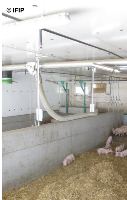
Canon à paille nécessitant la présence d'un opérateur mais permettant un paillage au cas par cas
